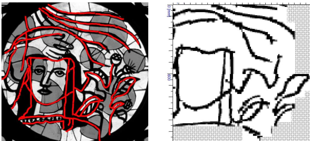
Fig. 3. Position des armatures dans le médaillon de l'Annonciation à Courfaivre déterminée avec un aimant (à gauche) et à l'aide d'un profomètre Hilti Ferroscan PS200 avec analyse et interprétation automatisées (à droite). © Auteurs.
